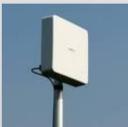
Grazie all'utilizzo dell'antenna a pannello integrata e degli standard 802.11a/n/ac, l'apparato permette il raggiungimento di elevati data rate fino 867Mbps.
