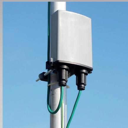
Linkit G1ESDP è un limitatore di sovratensione Ethernet per la protezione di sistemi digitali.
